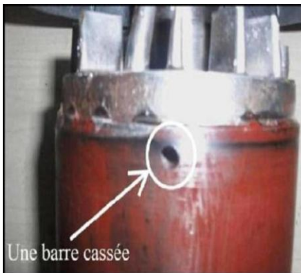
Fig. 3: Rotor avec une barre rotorique cassée
