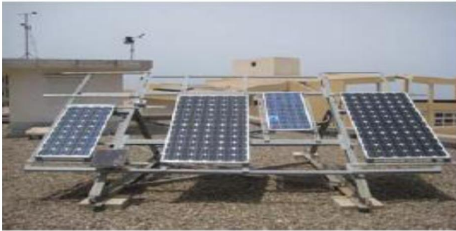
Fig. 1: Plateforme de tests 'outdoor' pour modules photovoltaïques (UDES)
