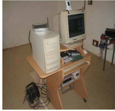
Fig. 3: Chaîne d'acquisition de température et la mini station météorologique reliées à l'ordinateur
