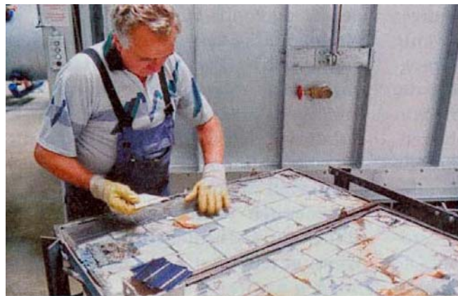
Fig. 13: Récupération manuelle des cellules solaires à partir des modules traités thermiquement [12]
