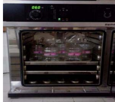
Fig. 4: Etuve contenant les dessiccateurs
