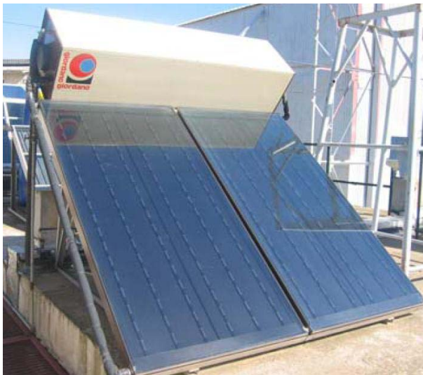
Fig. 1: Installation expérimentale (chauffe eau) à Bouzaréah, Alger
