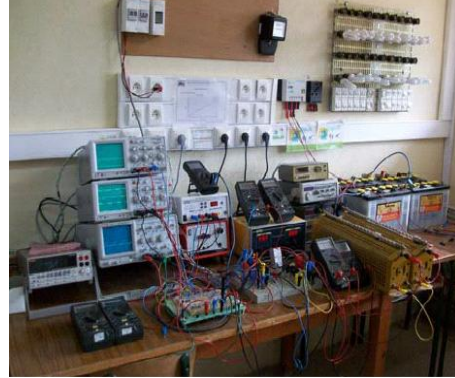
Fig. 12: Banc de mesure pour caractériser panneaux et systèmes PV
