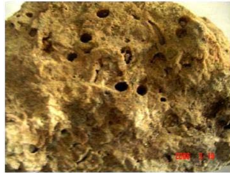
Fig. 11: Echantillon du traversin (vacuoles)
