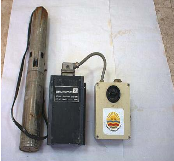
Fig. 7: Système de pompage SP3
