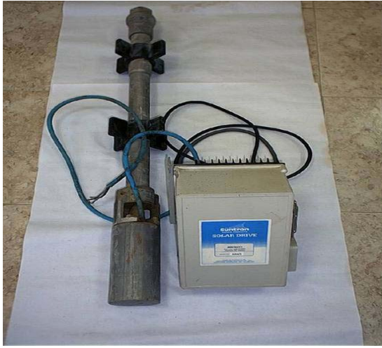
Fig. 1: Système de pompage SP1
