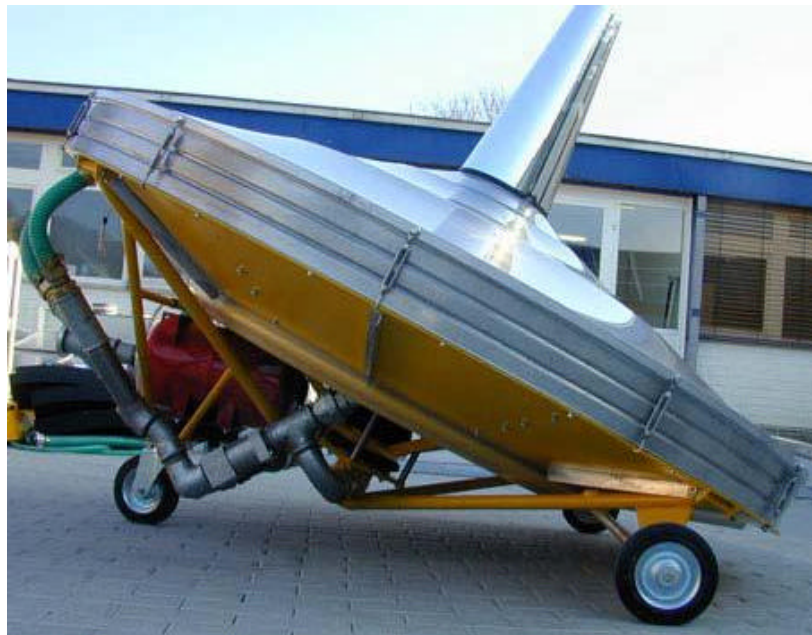
Fig. 5 : Moteur Stirling solaire sans concentration SUNPULSE [8]
