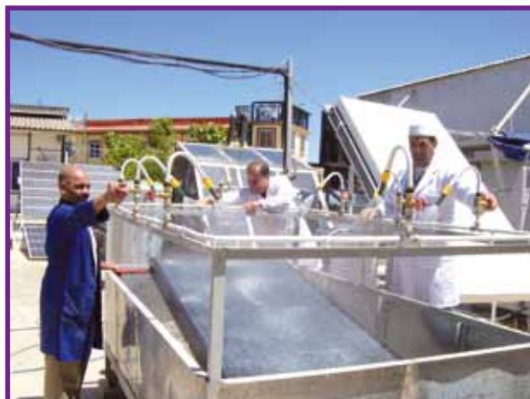
Le banc de tests d'étanchéité du capteur solaire, CDER, Bouzaréah – Alger
