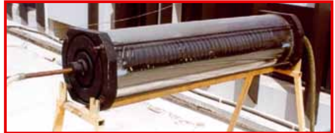
Figure 5 . Chauffe eau solaire en forme cylindrique [5]
