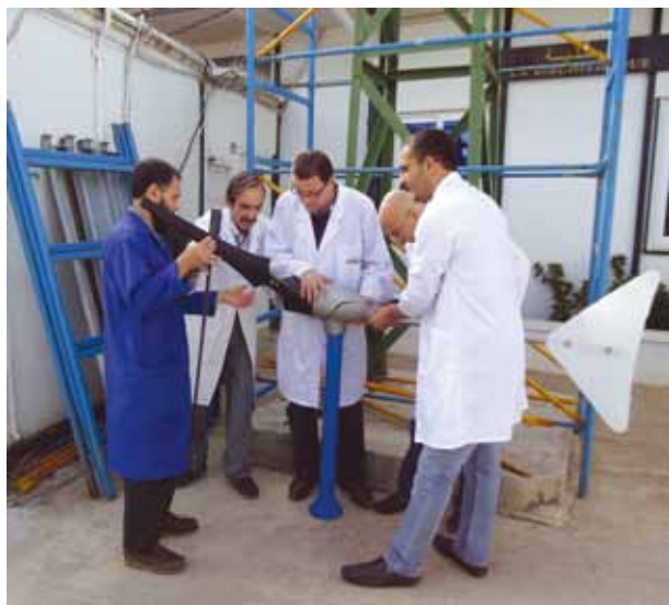
Montage du banc d'essai de pompage de l'eau par aérogénérateur
