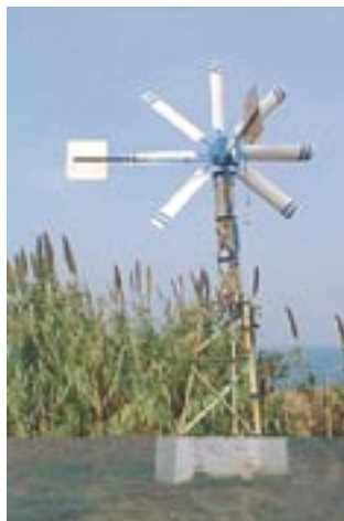
L'éolienne de pompage en fonctionnement sur puits
