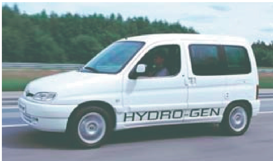
Les essais du prototype HydroGen, sur la base d'un Peugeot Partner, ont constitué, au début des années 2000, un jalon important dans la réalisation d'un véhicule équipé d'une pile à combustible, alimentée en l'occurrence en hydrogène comprimé. Le CEA est associé au groupe PSA-Peugeot-Citroën dans ce développement.
