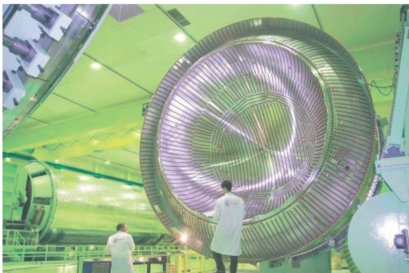
Étages cryogéniques du lanceur d'Ariane 5 en cours de soudage chez Cryospace (étage supérieur ESC-A au premier plan et étage principal EPC au second). La propulsion spatiale, bien que quantitativement limitée, constitue une première utilisation industrielle de l'hydrogène en tant que vecteur énergétique.
