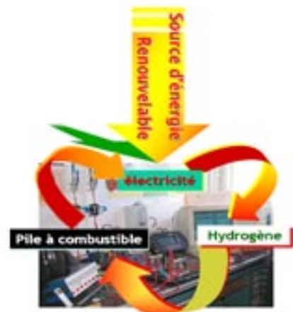
Schéma 01 : Contexte énergétique inépuisable « Source d'énergie renouvelable » → électricité → Hydrogène → Pile à combustible → électricité.
