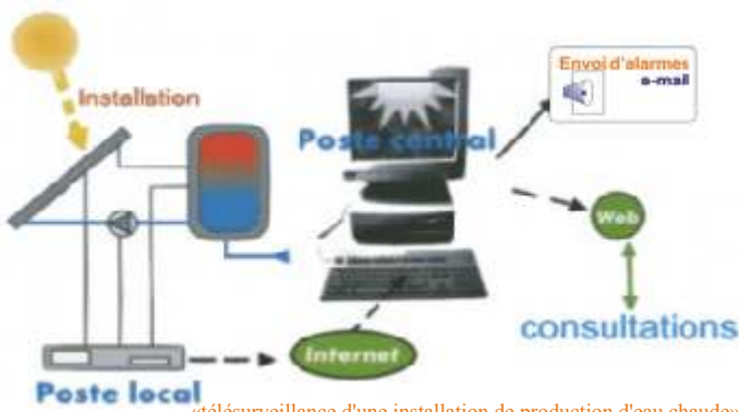
«télesurveillance d'une installation de production d'eau chaude»
