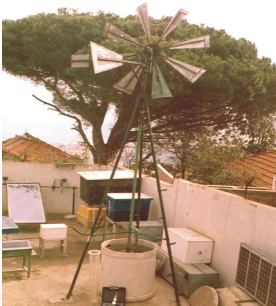
Expérimentation d'une éolienne de pompage - CDER Bouzareah
