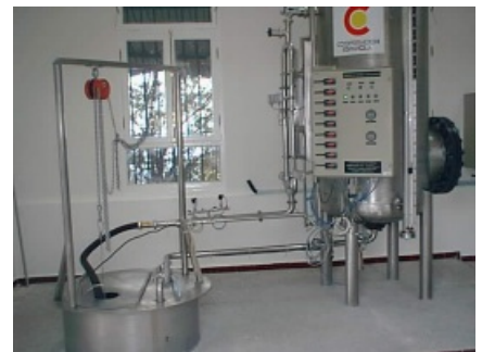
Banc d'essais de systèmes de pompage photovoltaïque Equipe de recherche A. Hadj Arab 1 , A. Hamidat 1 , M. Belhamel 1 , F. Chenlo 2 et M. Alonso 2 1 CDER, Algérie - 2 CIEMAT, Espagne
