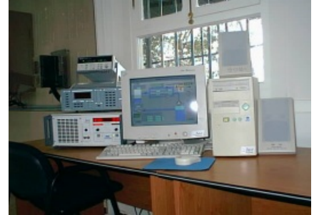
Datalogger, Wattmètre, Alimentation DC et Ordinateur
