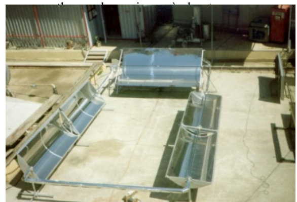
Concentrateurs solaires cylindro-paraboliques Pour la production de la vapeur d'eau CDER
