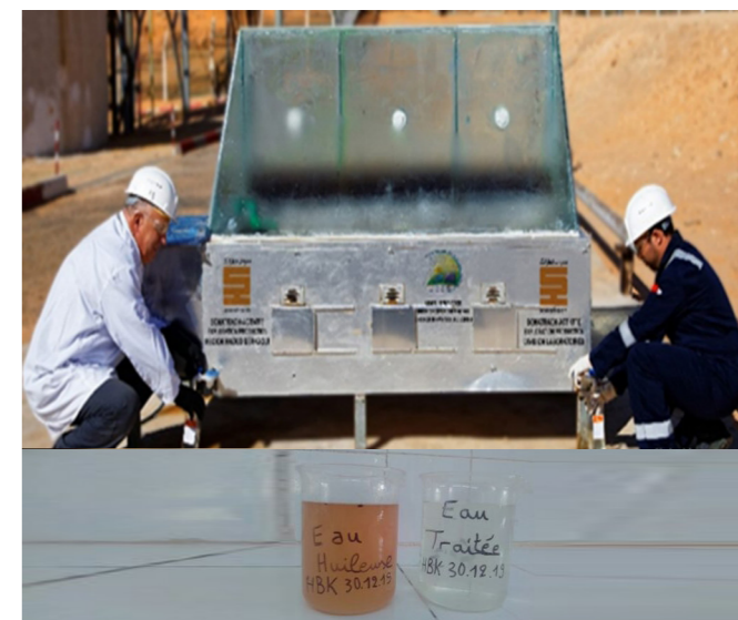
Figure 3. Expérimentation du pilote d'épuration solaire pour le traitement des eaux huileuses (HBK/Sonatrach, Ouargla, 2020).
