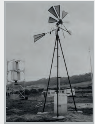
Eolienne de pompage à axe vertical à 2 étages de type "Savonius".
