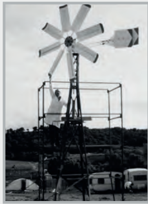
Eolienne de pompage à axe horizontal "El Hayat"
