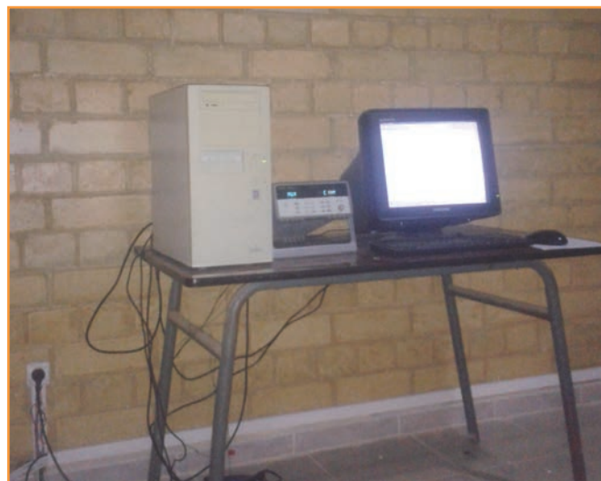
Figure 5: Système de mesure et d'acquisition de données pour les deux systèmes solaires
