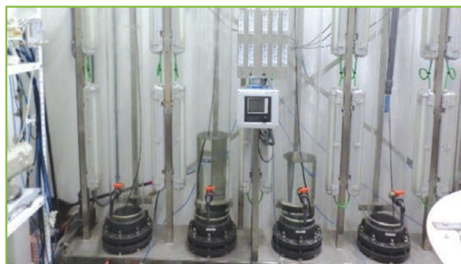
Figure 2: Photobioréacteur tubulaire à IMDEA
