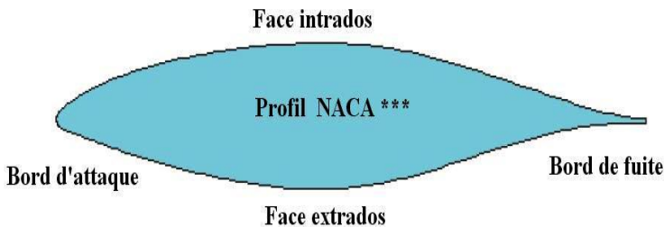
Fig. 1: Profil standardisé d'une pale d'éolienne
