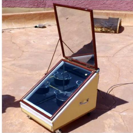
Fig. 7: Vue du cuiseur solaire de type boîte à surface réceptrice inclinée avec réflecteur additionnel réalisé à l'unité
