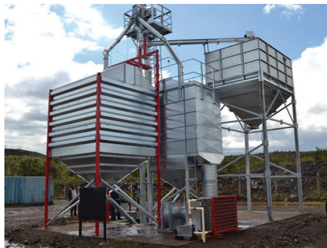
Figure 7. Séchoir à grains utilisant la vapeur géothermique, Menengai, Kenya [7].
